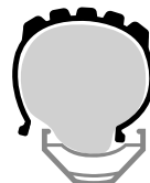
Figura 29. Camera d'aria all'interno del cerchio
