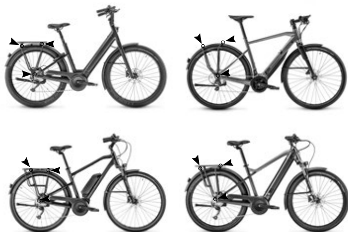
Diagrama 35. Puntos de fijación en los diferentes portaequipajes representados por las flechas negras
