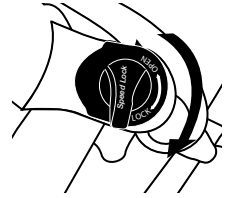
Afbeelding 20. Hendel in de vergrendelde stand
