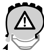
Abb. 27. Schlauch zwischen Reifen und Felge eingeklemmt
