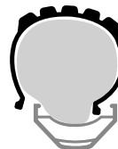
Abb. 29. Schlauch in der Felge
