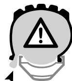
Figure 27. Chambre à air coincée entre le pneu et la jante
